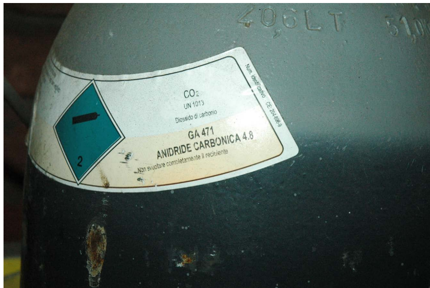
Figur 24. Etikett på CO2-behållaren. Renheten indikeras med kod 4.8 (d.v.s. 99,998 %).
