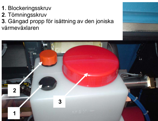
Figur 22. Avkylningsvattentank Sedd uppifrån.
