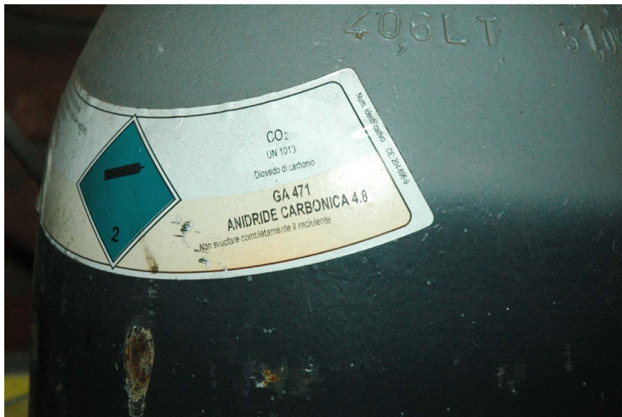
Figur 27. Etikett på CO2-behållaren. Renheten indikeras med kod 4.8 (d.v.s. 99,998 %).
