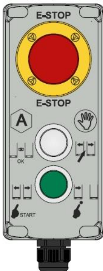
Fig. 4 – Hyllans kontrollpanel – beskrivning av knappfunktioner
