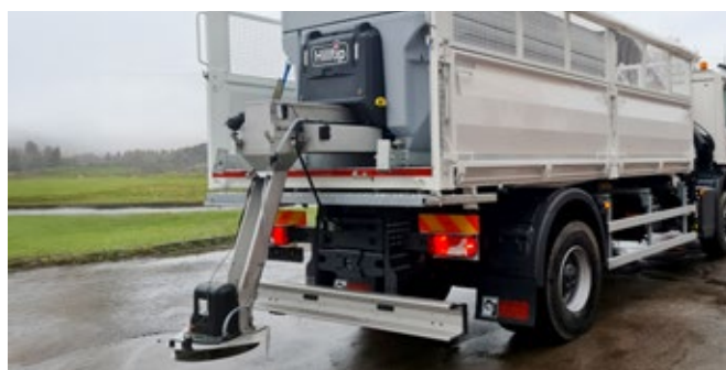
Förlängd ränna och förlängt matningssystem, skruv eller kedja (tillval)
