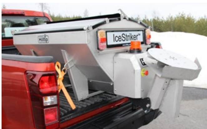
Uppfällbart spridartorn i rostfritt stål
