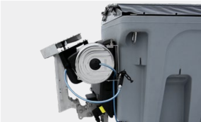
Uppfällbart spridartorn i rostfritt stål
