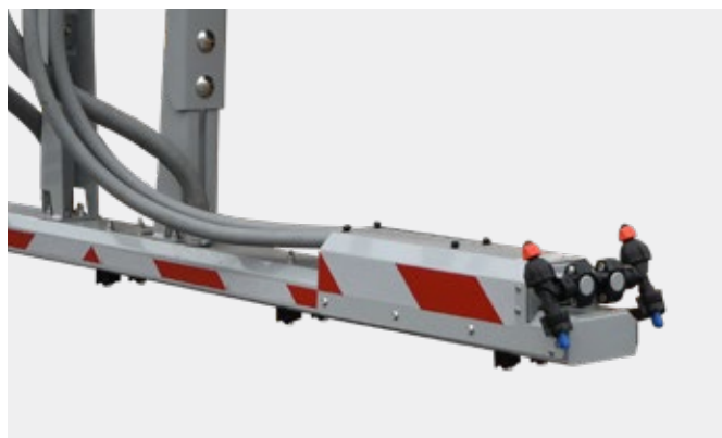
Dubbla sprutmunstycken för halkbekämpning även i högre hastigheter
