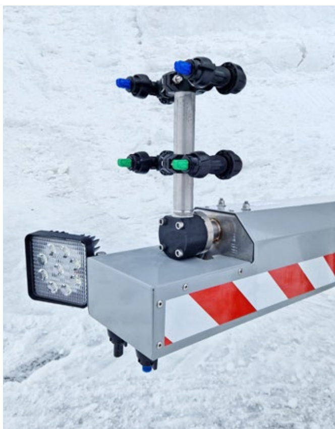
Dubbel sprutbalk med sidomunstycken och LED arbetsbelysning
