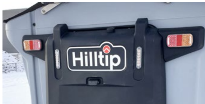
Varningsljus, bakljus och körriktningsvisare (tillval)
