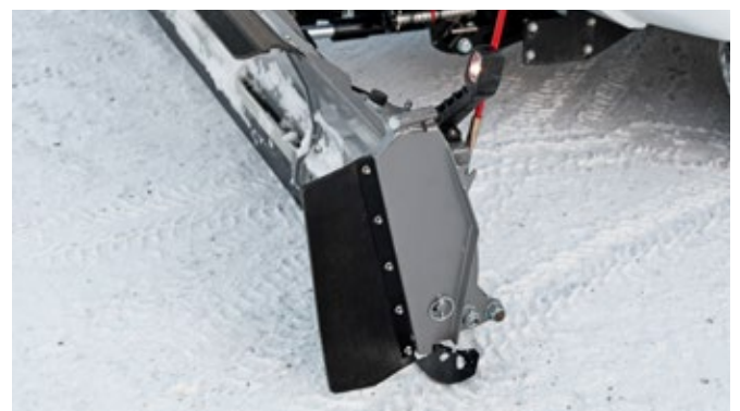
Ändplatta och LED-positionslys
