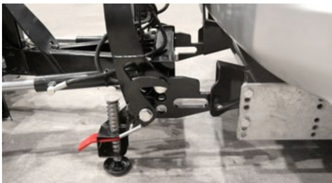
Quick hitch - lyft handtaget för att haka fast plogen till bilen
