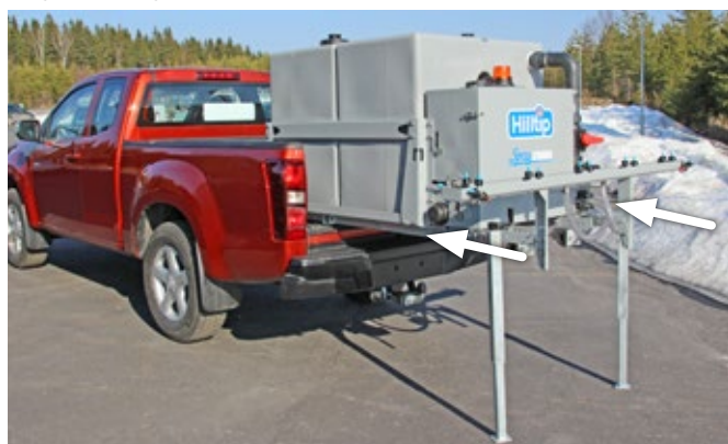
Benstativ (tillval) med rullskenor för att enkelt föra över och avlägsna vätskespridaren från fordonet
