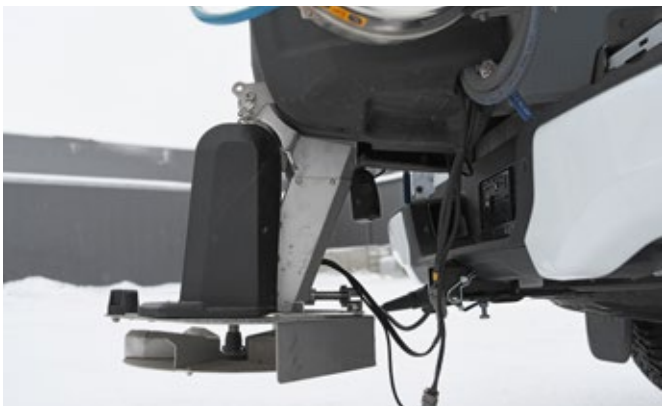
Uppfällbart spridartorn i rostfritt stål
