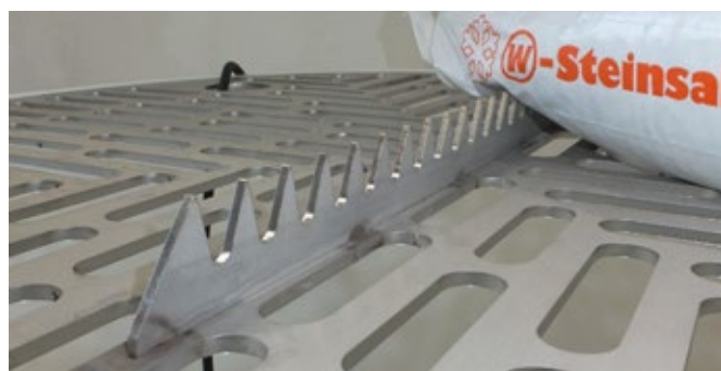
Taggig skärkant för öppning av saltsäckar
