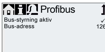
Fig. 36 Exempel på undermeny för Profibus®
